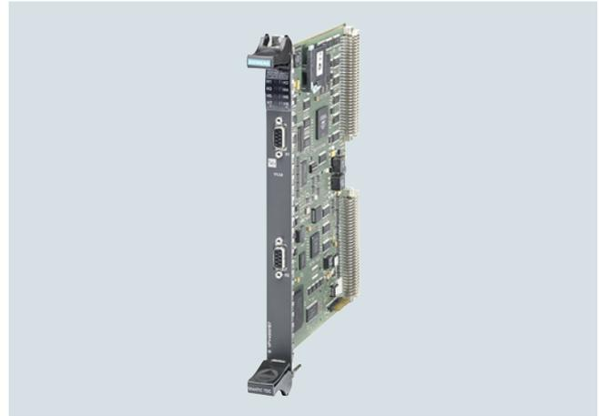
El módulo de comunicación CP50M1 dispone de dos interfaces PROFIBUS DP/MPI y una memoria de acoplamiento de 8 Mbytes para la comunicación de las CPUs entre sí. Las interfaces se pueden utilizar como maestro PROFIBUS DP, como esclavo o como maestro y esclavo al mismo tiempo, o bien como estación MPI.
