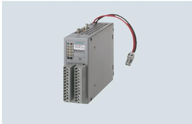
El módulo de interfaz sirve para conectar 8 salidas digitales con conversión por relés de los 24 V DC internos a los máx. 120 V DC/AC externos.
