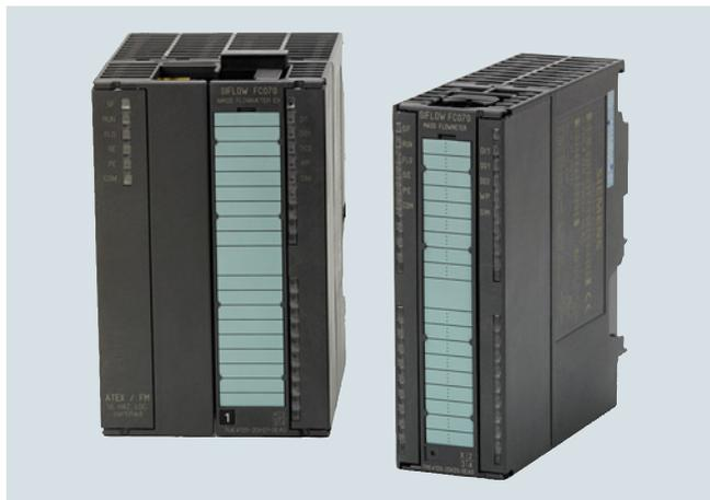
El SIFLOW FC070 ha sido diseñado usando los últimos avances en procesamiento digital de señales y responde a los requisitos de alto rendimiento, cortos tiempos de respuesta y alta inmunidad a ruidos generados en el proceso; además, se caracteriza por su gran facilidad de montaje, puesta en servicio y mantenimiento.
