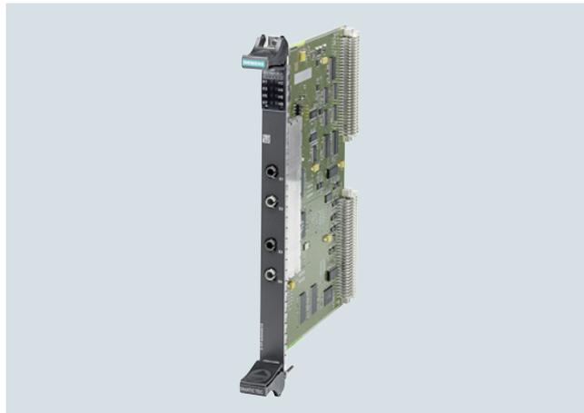
El módulo de acoplamiento CP53M0 permite conectar un sistema SIMATIC TDC a un sistema SIMADYN D para un intercambio rápido de datos, p. ej. para fines de ampliar un sistema SIMADYN D y instalado.
