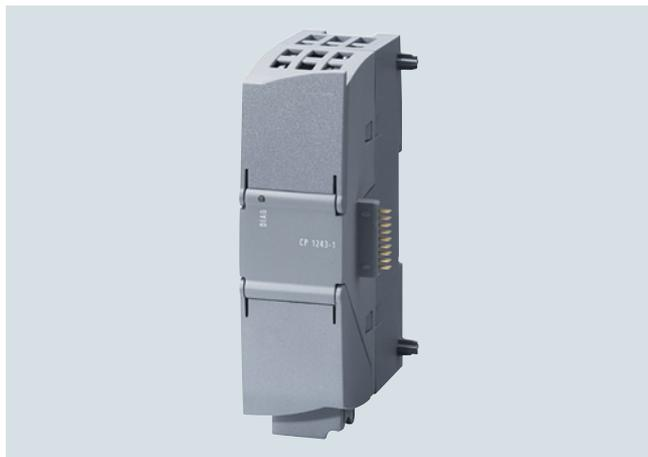
El procesador de comunicaciones CP 1243-1 sirve para conectar un SIMATIC S7-1200 a centrales de supervisión de telecontrol usando protocolos al efecto (DNP3, IEC 60870-5-104, TeleControl Basic) vía redes remotas así como para la comunicación de seguridad a través de redes basadas en IP.
