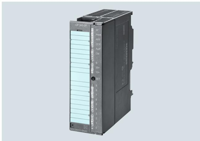
El procesador de comunicaciones CP 343-2P es el maestro AS-Interface para el SIMATIC S7-300 y la unidad de perifería descentralizada ET 200M con posibilidades de parametrización confortables.
