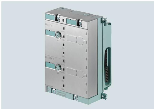
El SIMATIC RF170C es un módulo de comunicación para conectar los sistemas de identificación SIMATIC al sistema de periferia descentralizada ET 200pro. Con el RF170C pueden operar los lectores (SLG) de todos los sistemas RFID, los lectores ópticos MV400 y los lectores ópticos de mano MV300. Además, el RF170C dispone de una interfaz RS 232/RS 422 universal a la que se pueden conectar dispositivos que soporten el protocolo Freeport.
