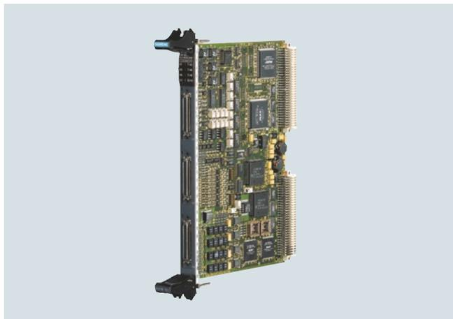
El módulo de periferia SM500 pone a disposición entradas/salidas analógicas y digitales así como conexiones para encoders incrementales y absolutos.
