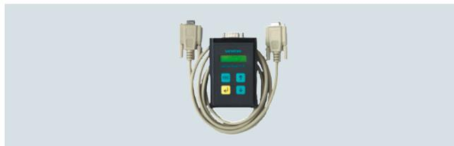
El Service Tool se puede utilizar para la entrada de comandos de desplazamiento, la modificación de los parámetros de desplazamiento y la lectura de los parámetros aprendidos, los estados de puertas, las señales de entrada y salida y los datos de mantenimiento.
