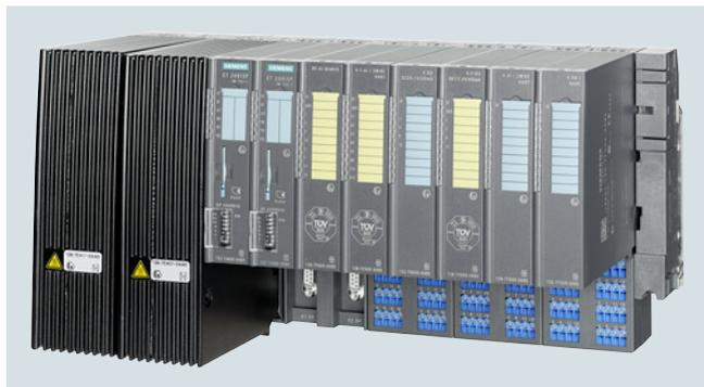
ET 200iSP es un sistema de periferia E/S modular, de seguridad intrínseca y con grado de protección IP30, que puede funcionar en atmósferas de gas y de polvo a una temperatura ambiente de -20 a +70 °C. Está optimizado para su uso con SIMATIC PCS 7 y SIMATIC S7, pero también se puede integrar en otros sistemas (p. ej. en SIMATIC S5) por medio de archivo GSD.
