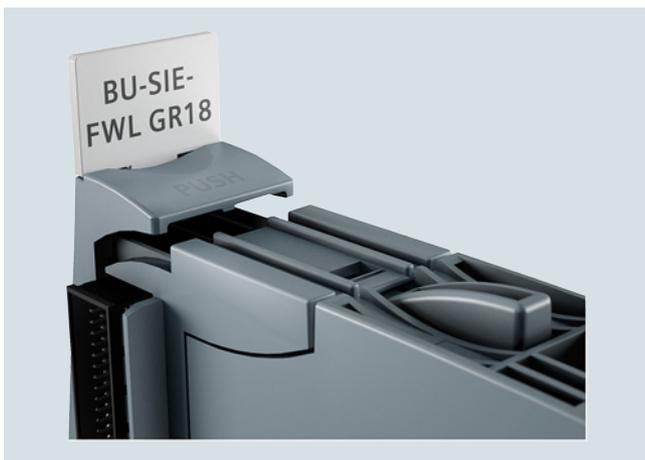
Opcionalmente, en cada estación de cabecera, BusAdapter, BaseUnit y módulo de periferia se puede incorporar una etiqueta de identificación por referencia. Las etiquetas de identificación por referencia se suministran en paquetes de 10 esteras con 16 etiquetas cada una. Dichas etiquetas se pueden imprimir en impresoras de tarjetas por transferencia térmica o plotters, o también se pueden dotar de etiquetas. Ventajas frente a las etiquetas que se pegan directamente:
