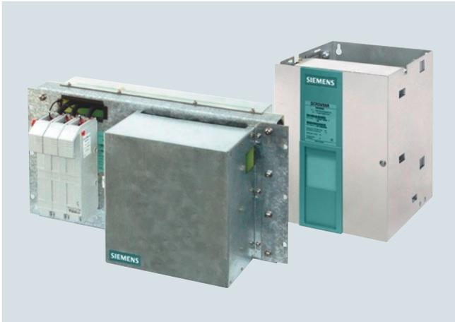
**SICROWBAR AC** se utiliza para proteger los semiconductores (tiristores y diodos) de los convertidores contra sobretensiones entre las fases de una red trifásica. El área de aplicación no se limita a la protección de convertidores para accionamientos de corriente continua, sino que cubre igualmente las unidades de alimentación y realimentación con tiristores de accionamientos de corriente alterna.
