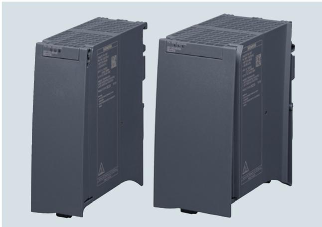
La fuente de alimentación monofásica SIMATIC PM 1507 (PM = Power Modul) dispone de conmutación automática del rango de tensión de entrada y está óptimamente adaptada en diseño y funcionalidad al controlador SIMATIC S7-1500. Se encarga de alimentar con 24 V DC todos los componentes de un sistema S7-1500 como CPU, alimentación del sistema (PS), circuitos de E/S de los módulos de E/S y, dado el caso, los sensores y actuadores.
