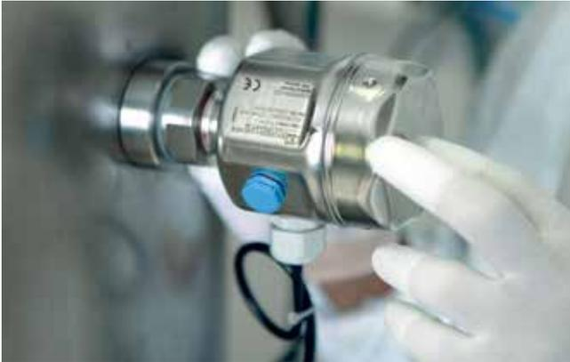
Mezcla de producto preliminar, intermedio y final, determinación de la densidad exacta o la concentración, monitorización de la calidad y control del proceso; todas estas tareas constituyen la razón de la medición de la densidad del fluido. Endress+Hauser ofrece medidores por lámina vibrante con electrónica desarrollada específicamente para medición de densidad. Estos permiten determinar la densidad y concentración de una forma sencilla y rápida en los distintos ámbitos industriales.
