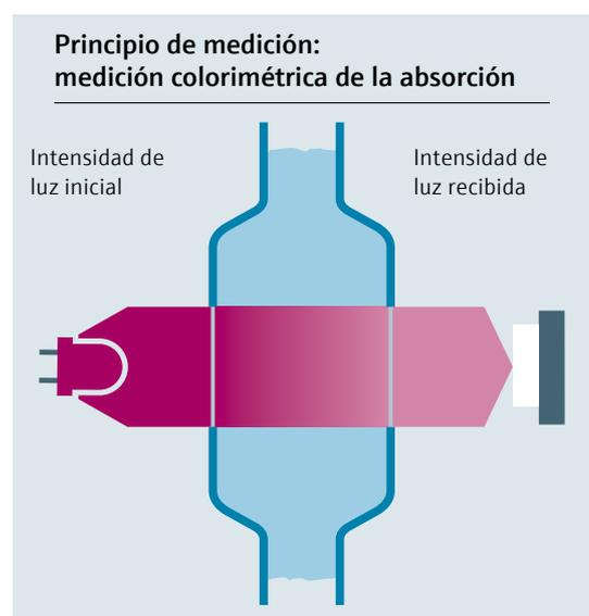
Absorción = medición de la atenuación de la luz con respecto a la intensidad de la luz entrante
